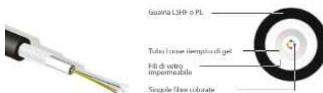
Cavo in fibra ottica di tipo loose
