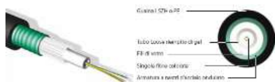
Cavo in fibra ottica armato da esterno
