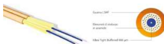
Cavo in fibra ottica di tipo tight
